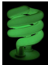
Abbildung B.6: Blaue Kompaktleuchtstofflampe. Die erhöhte Intensität im Wellenlängenbereich von 300 nm bis 400 nm wird durch die 0. Ordnung verursacht.
