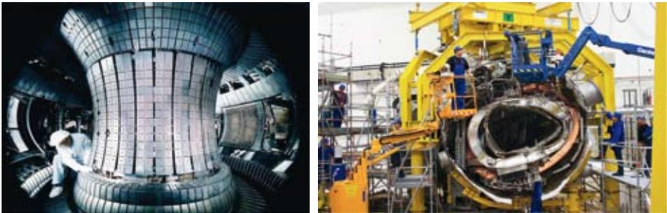
Abb. 5: Die Plasmakammer des Tokamaks ASDEX Upgrade in Garching (links) und der im Aufbau befindliche Stellarator Wendelstein 7-X in Greifswald (rechts)
