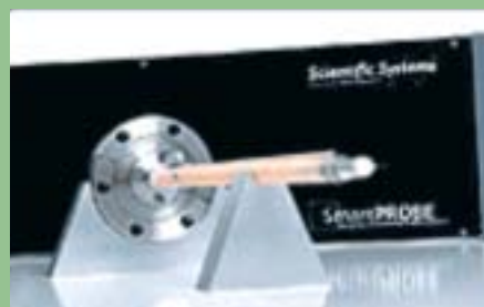
Ionenflusssonde (IFTM): ermöglicht die Echtzeitüberwachung der Plasmadichte.
