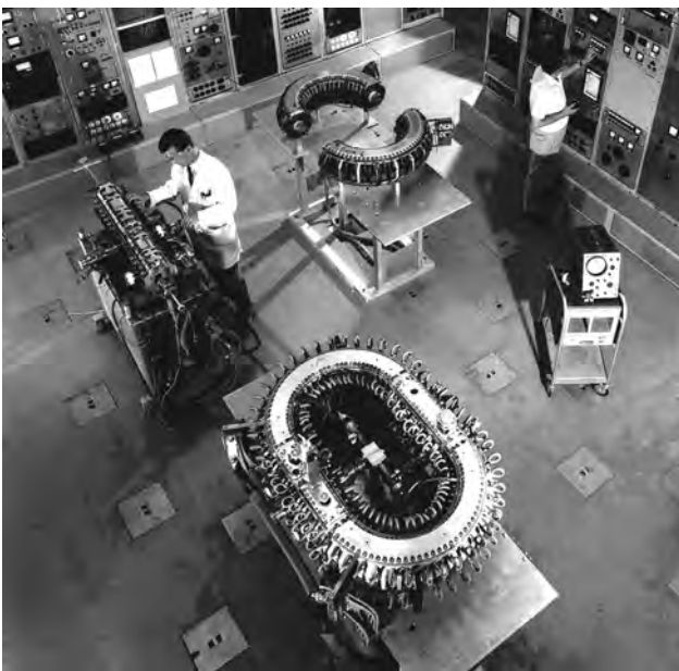
Wendelstein 1, der erste IPP-Stellarator, ging 1960 in Betrieb. Hinten: Wendelstein 1-B, links Wendelstein 4.
