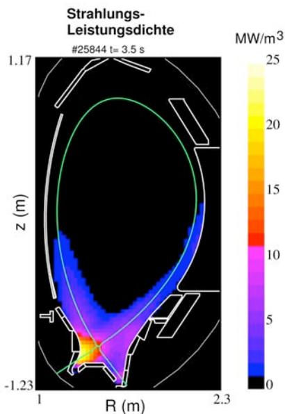
*Querschnitt durch das Plasma der Fusionsanlage ASDEX Upgrade, so wie es die Messgeräte sehen, die das vom Plasma abgestrahlte Röntgen- und Ultraviolett-Licht registrieren. Am unteren Plasmarand zeigt sich starke Strahlung – die gewünschte Kühlung durch die eingeblasene Stickstoff-Verunreinigung. Trotz hoher Heizleistung von 20 Megawatt nehmen die Divertorplatten daher keinen Schaden. Im heißen Zentrum stellen die Messgeräte keine Strahlung fest – dort bleibt das Plasma sauber.
