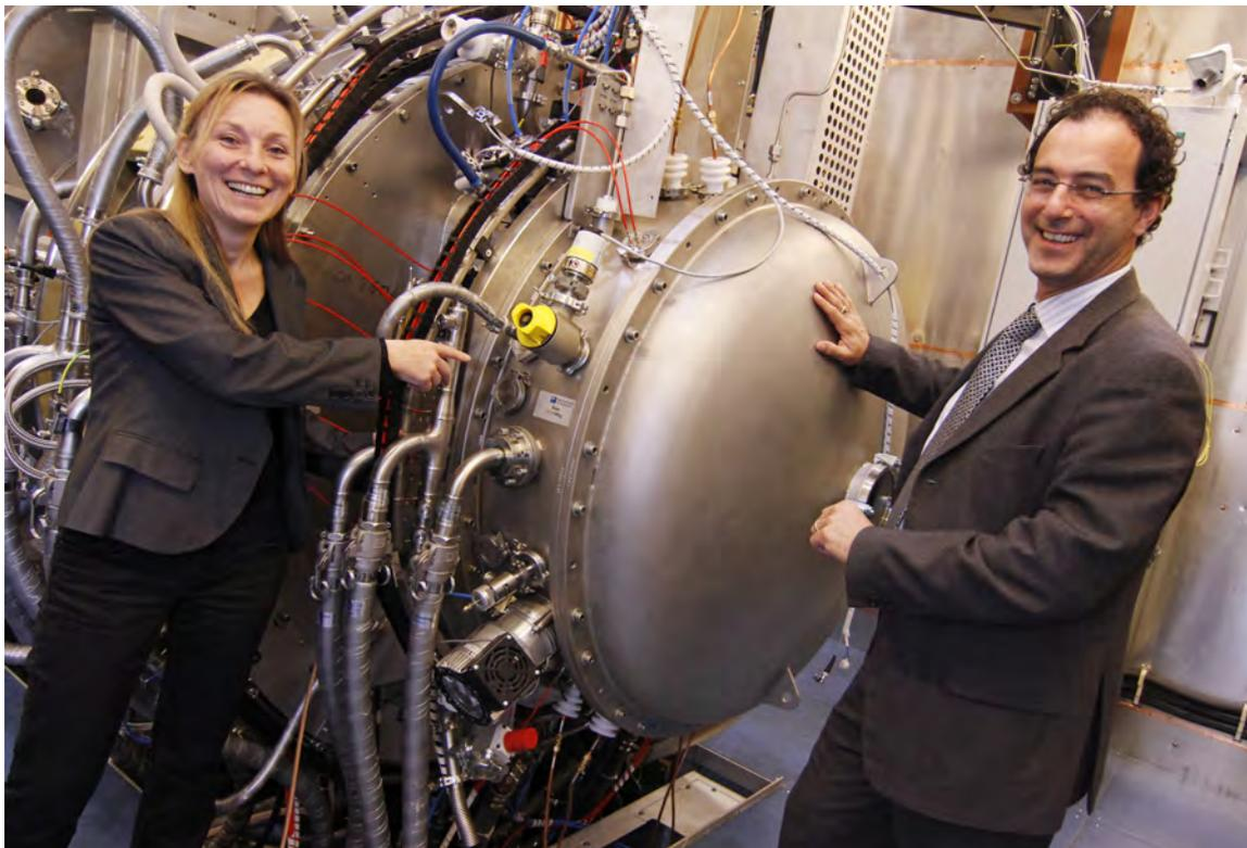
*Fertig: Die neuartige Ionenquelle des IPP (ganz rechts), eingebaut in den gerade vollendeten Teststand ELISE. Professor Ursel Fantz vom IPP und Dr. Antonio Masiello von „Fusion for Energy“ nehmen die Anlage in Betrieb. Der hier erzeugte baumstamm dicke Teilchenstrahl soll die gewaltige Leistung von 1,2 Megawatt transportieren. (Foto: IPP, Robert Haas)*
