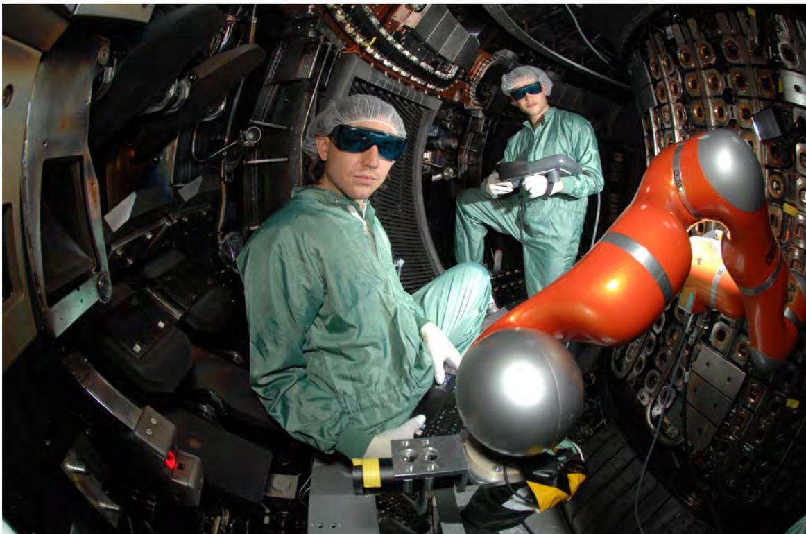
*Bolometer-Sichtlinien werden im Plasmagefäß der Fusionsanlage ASDEX Upgrade mit Hilfe eines Roboters vermessen. (Foto: V. Rohde, IPP)*
