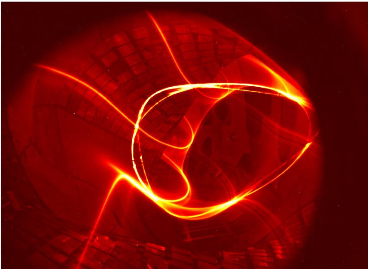
*Flussflächen-Diagnostik: Das Foto kombiniert die Leuchtspur eines Elektronenstrahls auf seinem vielfachen Umlauf längs einer Feldlinie durch das Plasmagefäß mit den Bildpunkten, die er auf einem fluoreszierenden Stab hinterlässt, der durch die Bildebene geschwenkt wird. Der schnell bewegte Stab ist wegen der langen Belichtungszeit nicht zu sehen. (Foto: IPP, Matthias Otte)*
