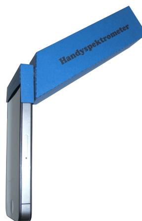
**Abbildung 3.7:** Seitenansicht des Handyspektrometers mit befestigtem Aufsatz, angebracht am iPhone4s von Apple.
