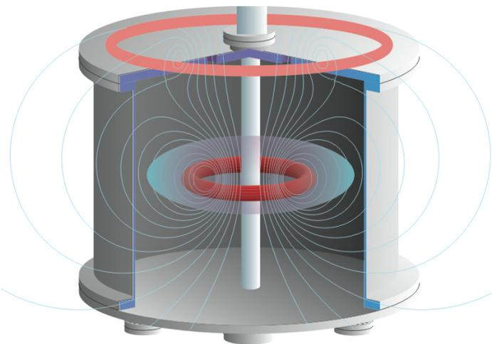
Wie im Weltall soll auch das Elektron-Positron-Plasma im Labor von einem magnetischen Dipolfeld eingeschlossen werden. In der geplanten, APEX-D getauften Anlage (A Positron-Electron Experiment Dipole) wird es von einer
