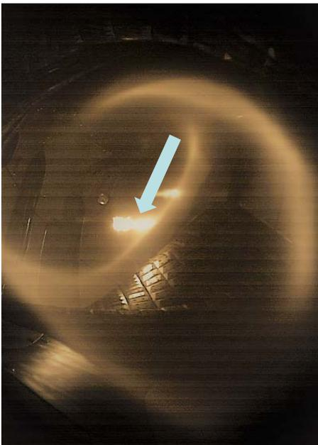
*Abb. 3 Blick in das Plasmagefäß von Wendelstein 7-X während der Pelletinjektion. Im unteren mittleren Bereich sieht man die Kacheln zum Schutz der Gefäßwand, die durch das sichtbare Plasmalicht (unscharfe Bereiche) beleuchtet werden. Die Pelletspur ist mit einem Pfeil gekennzeichnet.*
