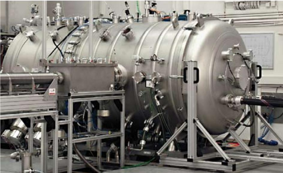
Abb. 4: Der Wärmefluss-Teststand GLADIS.
