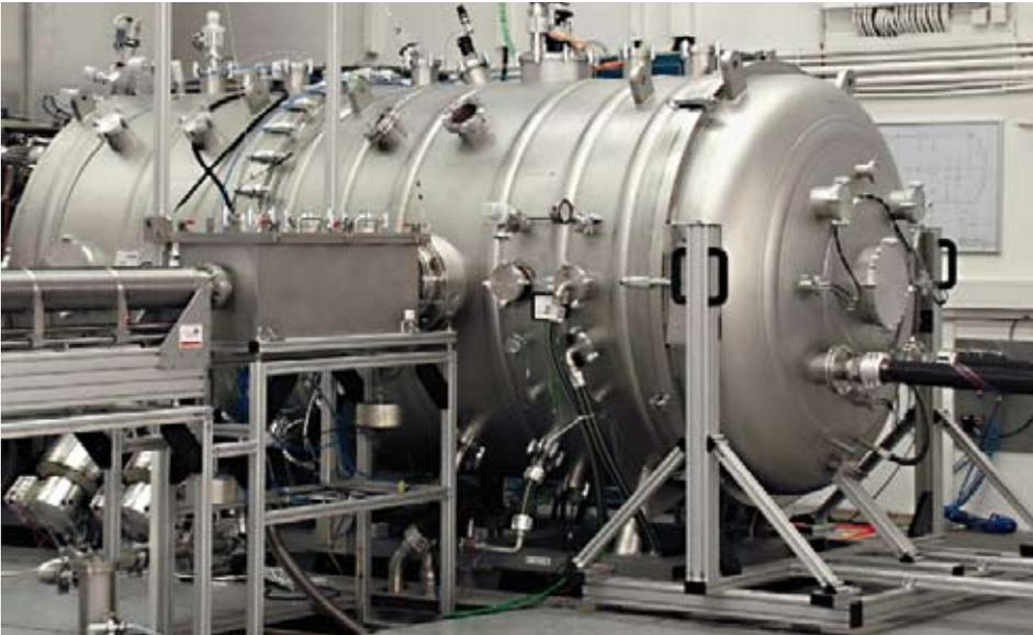
Abb. 4: Der Wärmefluss-Teststand GLADIS.
