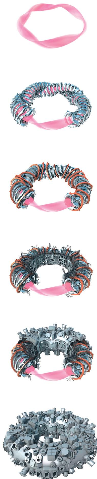
Stellarator Wendelstein 7-X: Die Abbildungen zeigen von oben nach unten die Plasmaform, die supraleitenden Stellarator-Magnetspulen, die geraden Magnetspulen, Verkabelung, Kühlleitungen und innere Stützstruktur, Teile des Außengefäßes und das gesamte Außengefäß. (Grafik: MPI für Plasmaphysik)
