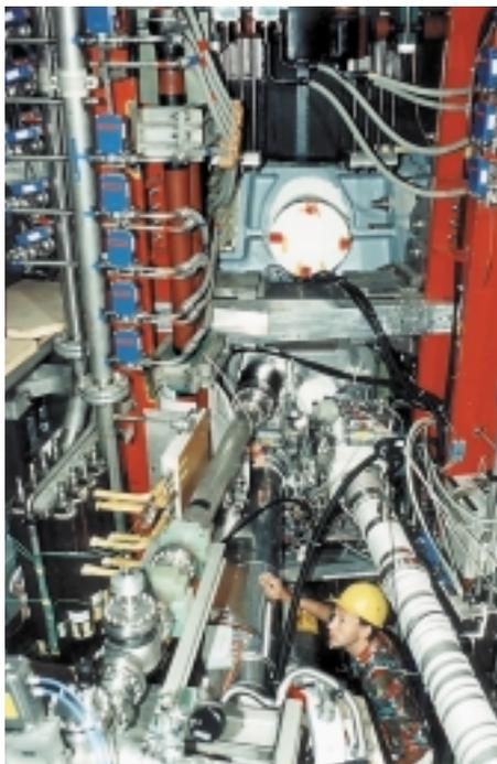
**Vakuumpipen, die an das Plasmagefäß von ASDEX Upgrade angebaut sind, führen weiche Röntgenstrahlung aus dem Plasma zu verschiedenen Spektrometern.**
