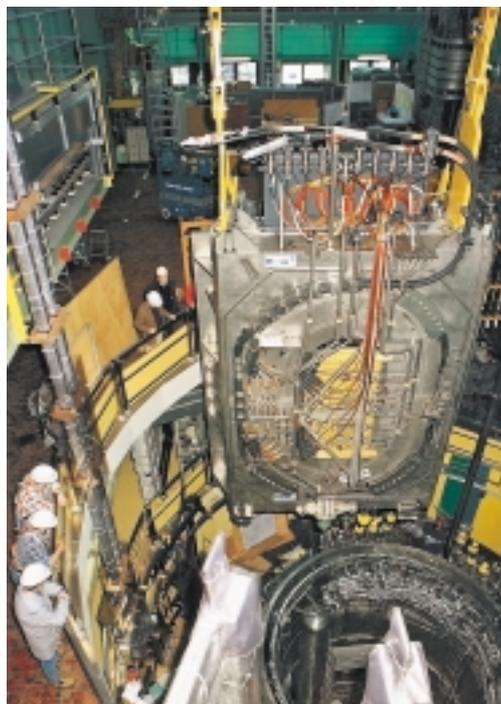
Test der supraleitenden ITER-Modellspule im Forschungszentrum Karlsruhe
