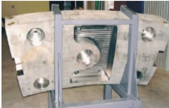
**Für ITER ist in der ersten Betriebsphase ein Abschirmblanket vorgesehen; erst später sollen auch Module des Brutblankets erprobt werden. Um die Herstellbarkeit des Abschirmblankets zu prüfen, wurden zwei Module in Originalgröße gefertigt. Hier einer der Prototypen.**
