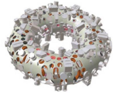
Wendelstein 7-X wird aus fünf nahezu baugleichen Modulen errichtet. Jedes Modul besteht aus einem Teil des Plasmagefäßes, seiner thermischen Isolation, zehn der supraleitenden Stellaratorspulen und vier Ebenen Spulen samt ihrer Verbindungen untereinander, der Verrohrung für die Kühlung der Spulen sowie einem Teil des stützenden Zentralrings und des Außengefäßes.
