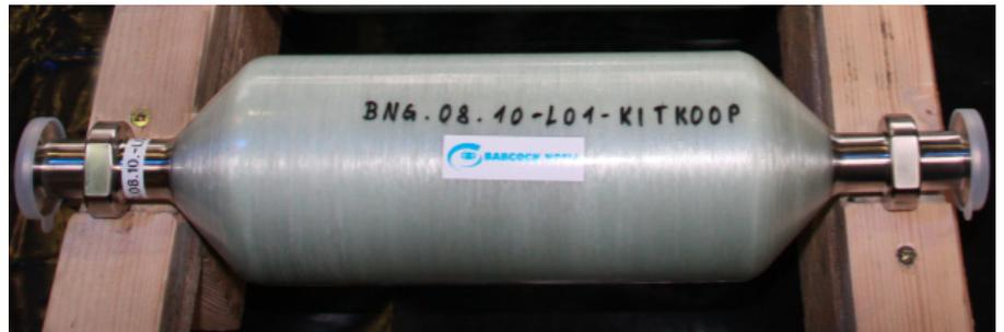
Industriell herstellbare Trenner für verschiedene Temperaturen werden von Babcock Noell realisiert. Die Tauglichkeit dieser Trenner wurde im KIT durch anspruchsvolle Hochspannungs- und Materialtests nachgewiesen. Selbst Belastungen bei  $-196\text{ }^{\circ}\text{C}$ , 70 kV und 60.0000 Zyklen haben die Prototypen unbeschädigt und gasdicht überstanden und sind somit für den Einsatz z. B. in ITER qualifiziert.
