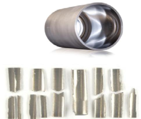
*Sprödbrech von Wolfram Massivmaterial und duktilen Verhalten des Wolframlaminats nach Kerbschlagbiegeversuch*
