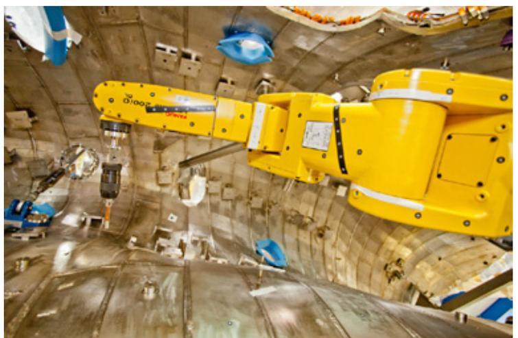
Roboter werden für das Positionieren von ca. 6000 Bolzen und Halterungen an den Innenwänden des Plasmagefäßes eingesetzt.
