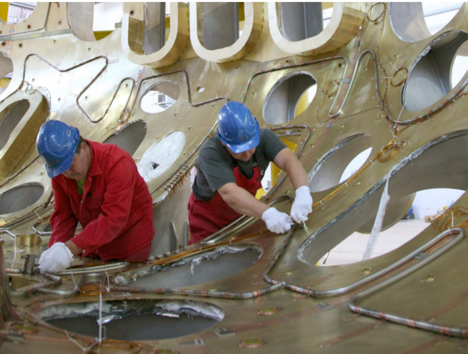
Montage der thermischen Isolation des Außengefäßes (Messingschilde)
