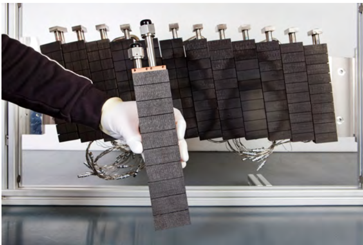
Eines der 890 Divertor-Elemente (vorne). Im Hintergrund: der Prototyp einer aus diesen Elementen zusammengesetzten Divertor-Platte nach dem Hitzetest im IPP-Prüfstand GLADIS. Die Belastungsspuren sind gut erkennbar.
