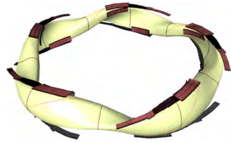
In zehn geschwungenen Doppelstreifen folgen die Divertor-Platten dem verwundenen Plasma. (Grafik: IPP)
