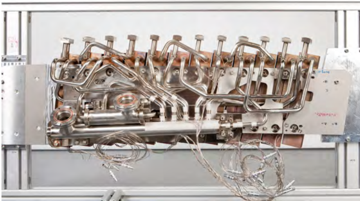
Rückseite der Divertor-Platte. Stählernen Rohre führen das Wasser in die Kühlkanäle in der Kupfer-Chrom-Zirkon-Platte. (Foto: IPP, Michael Herdlein)
