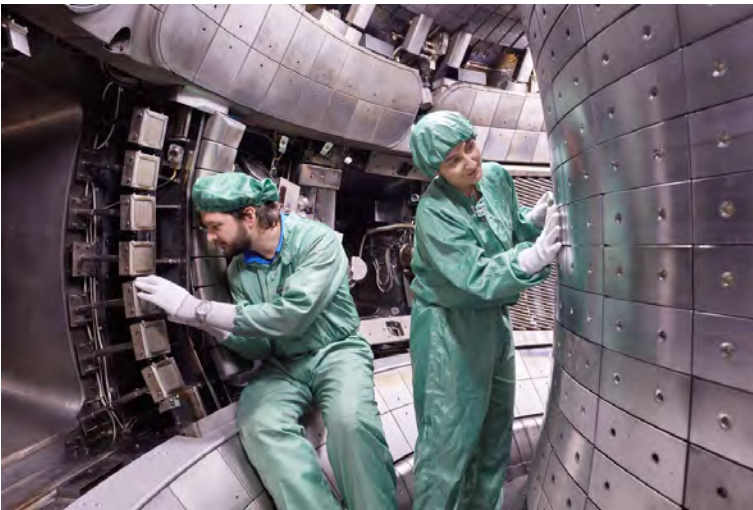
Das Plasmagefäß der Fusionsanlage ASDEX Upgrade (Foto: IPP, Bernhard Ludewig)
