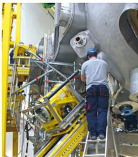
Etwa zwei Drittel der Stützen beherbergen Diagnostiken. Eine davon ist eine Laserdiagnostik, mit der sich – durch Streuung von Licht an den freien Elektronen – die Temperatur und Dichte des Plasmas berührungslos messen lassen (Thomson-Streuung).
