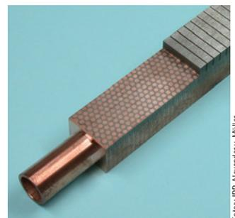
**Mock-up einer plasmabelasteten Komponente mit einer Wärmesenke, welche auf einer mit Kupfer infiltrierten Wolfram-Wabenstruktur basiert**
