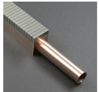
**Mock-up einer plasmabelasteten Komponente mit einer Wärmesenke aus wolframpartikelverstärktem Kupfer-Verbundwerkstoff**
