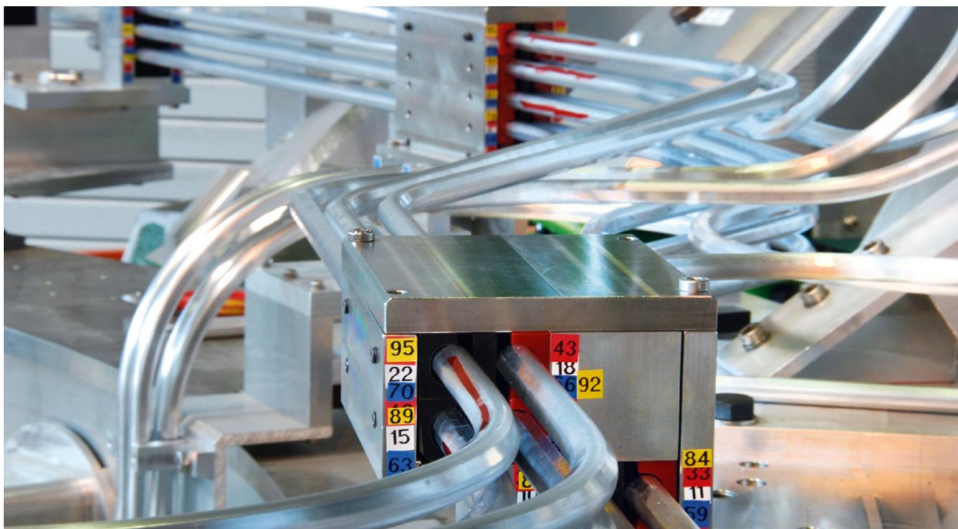
Geometrieprüfung der geformten Supraleiter
