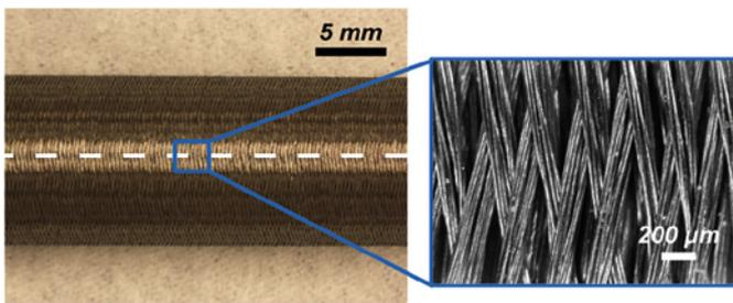
**Geflecht aus Wolframgarn; die einzelnen Filamente haben einen Durchmesser von gerade einmal 20 Mikrometern**
